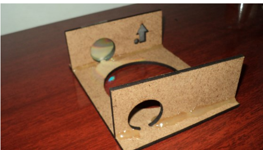
Figura 15: Primeiro aparato cortado a laser com otimização dos encaixes
