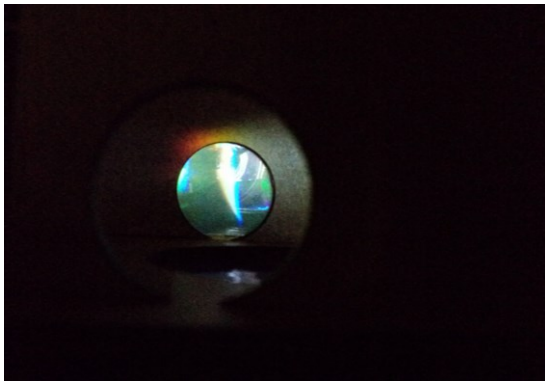
Figura 7: Seta vista invertida a partir da segunda difração na superfície do CD
