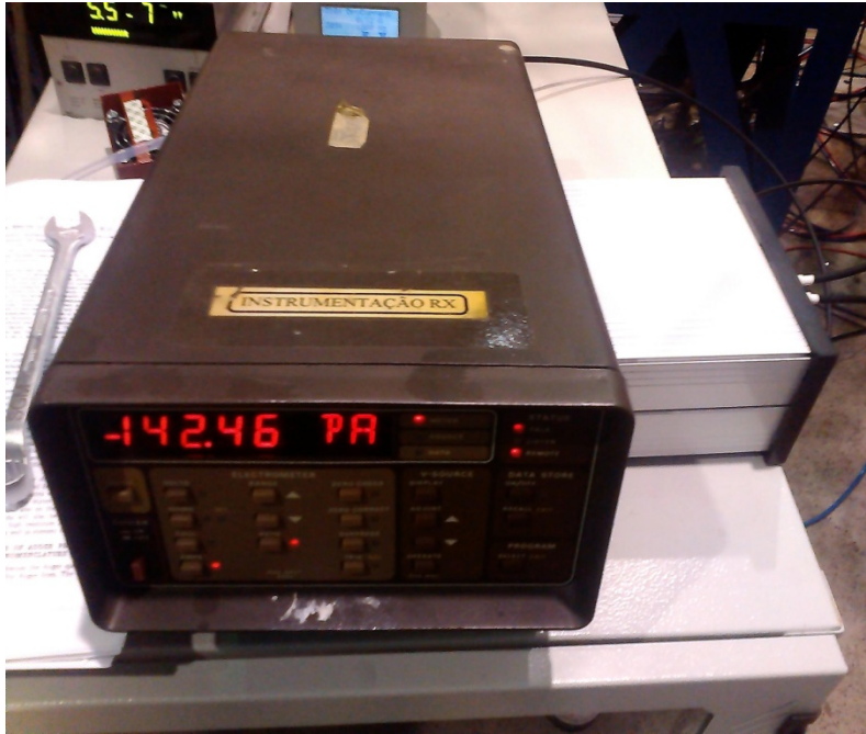
Figura 8- Amperímetro e caixa de controle de tensão usado no experimento
