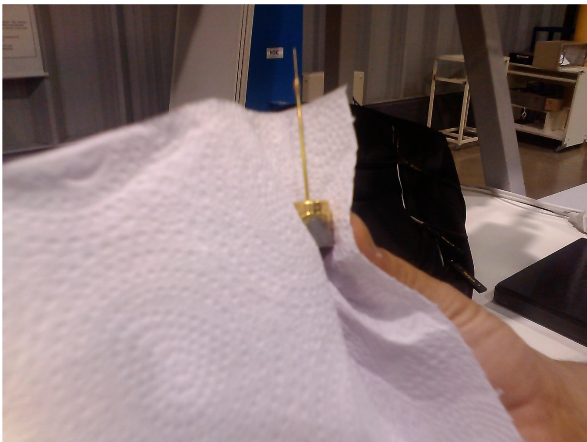
figura 1- Agulha recoberta com ouro para ser usada alvo e para ao mesmo tempo servir como coletora de elétron.
