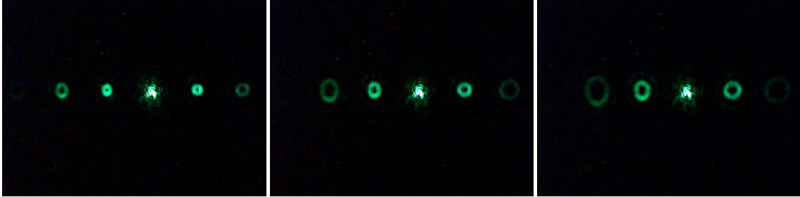
Figura 9: Vórtices gerados a partir de hologramas com auxílio do projetor. Cargas topológicas m=1, 2 e 3 , respectivamente. Essas imagens foram tiradas com a webcam localizada no foco de L3 (ver Figura 2) utilizada na montagem experimental.
