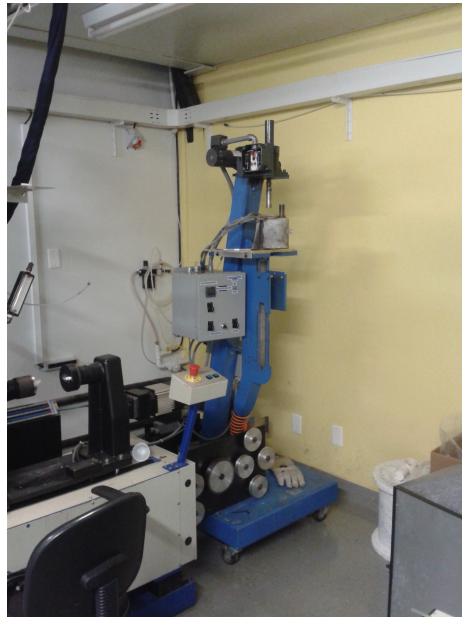
Figura 5: Extrusora do laboratório do Prof. Cristiano Cordeiro do Departamento de Eletrônica Quântica - UNICAMP
