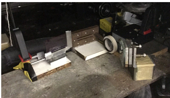
Figura 9: Parte da montagem com fonte de laser, lente convergente, suporte móvel para placa e espelho para a o feixe refratado.
