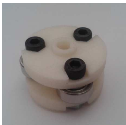
Figura 5 – Conjunto formado pelas peças rotor superior e rotor inferior com o s rolamentos. Esta peça promoverá a compressão da mangueira quando a bomba peristáltica for ligada.
