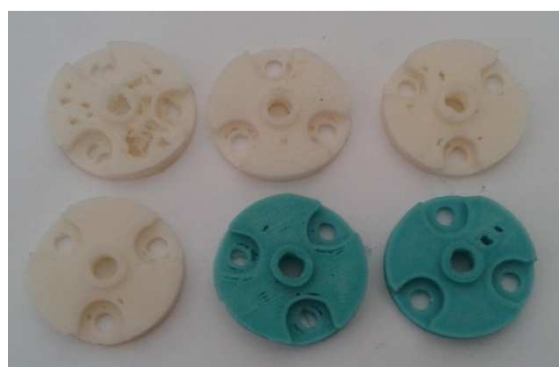
Figura 3 – Exemplos de peças que apresentaram problemas na impressão.
