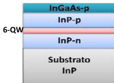
Figura 1: Estrutura epitaxial da amostra utilizada.
