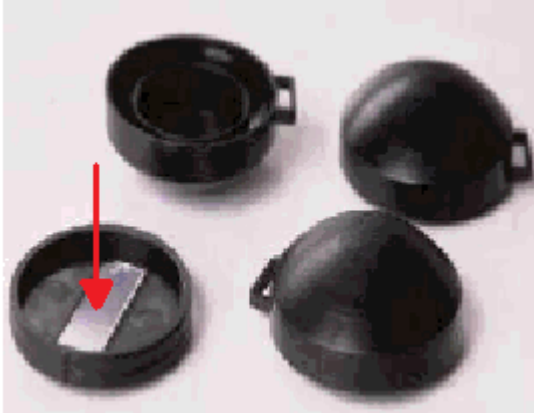
Figura 1: Montagem utilizada para detector CR-39, usado como espectrômetro alfa. O CR-39 é só o plástico transparente indicado pela seta.
