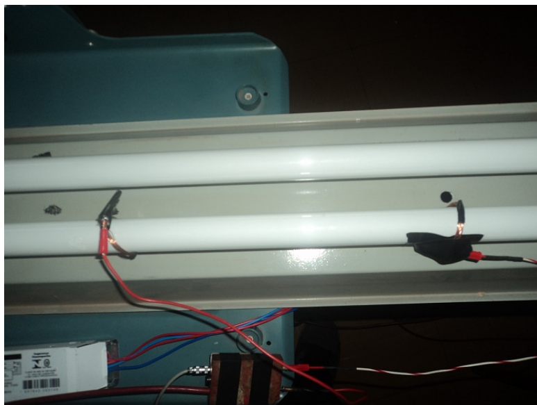
Figura 8: Anéis geradores do campo elétrico e caixa com o circuito RC.
