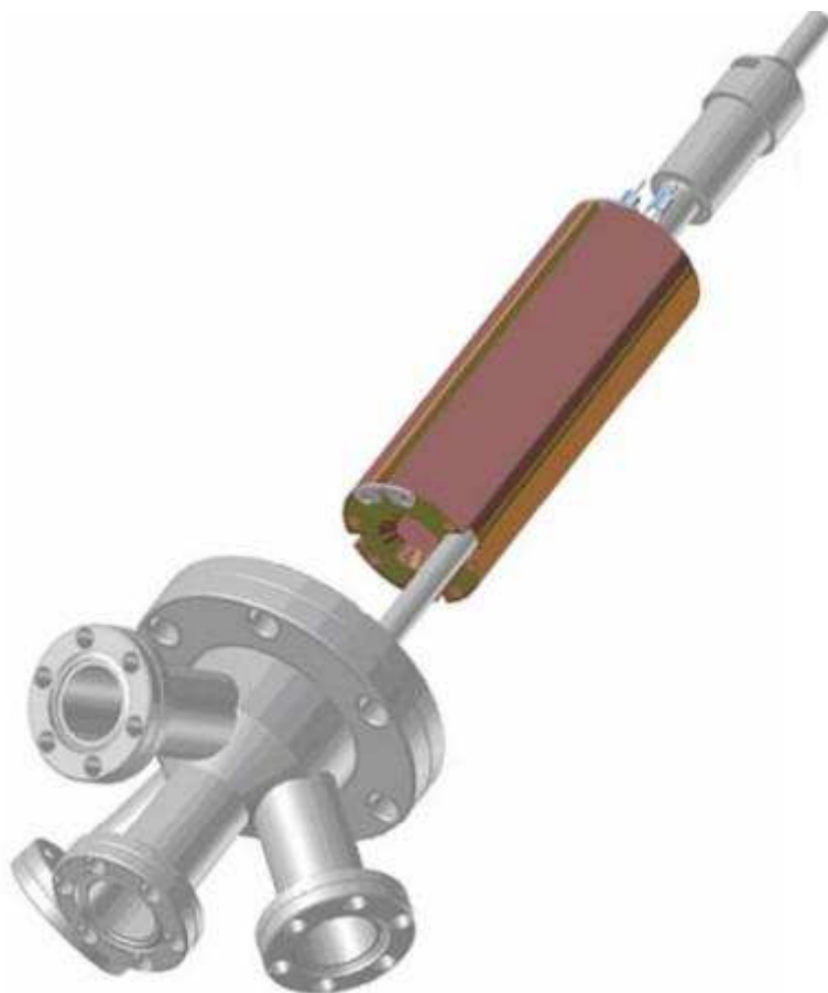
Figura 4 – Montagem da evaporadora
