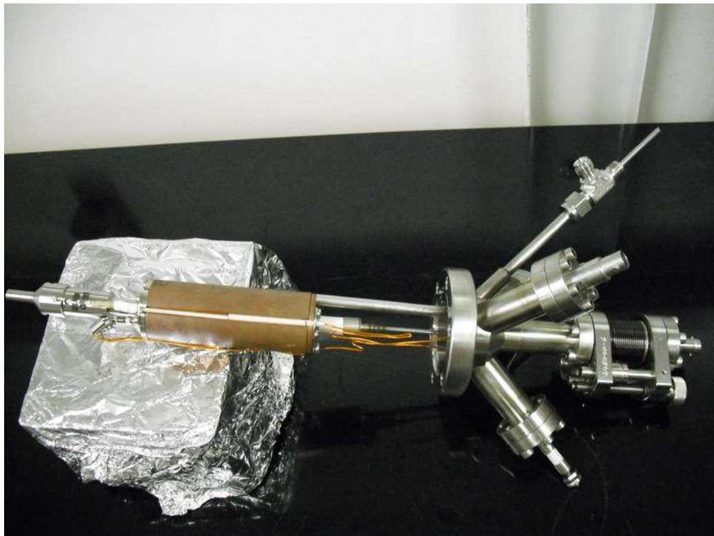
Figura 5 – Montagem final da evaporadora
