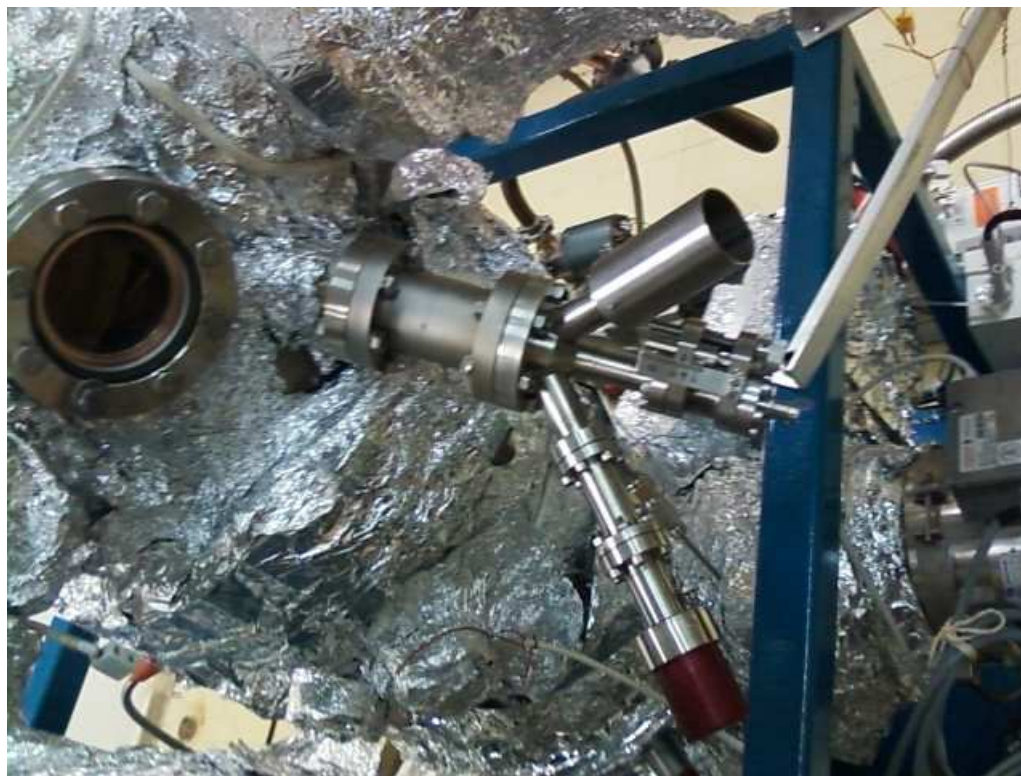
Figura 6 – Evaporadora montada no sistema STM
