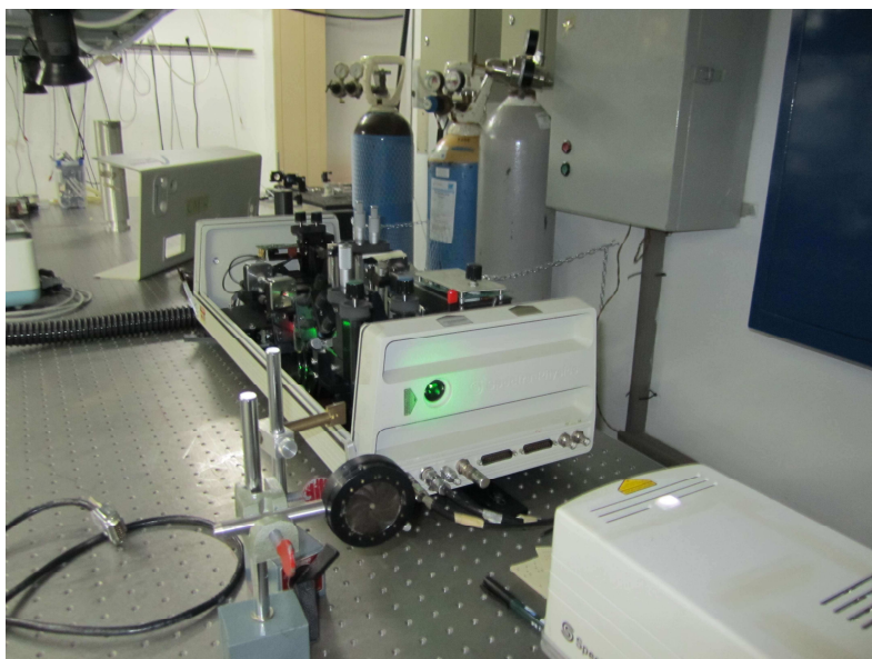
Fig. 1: Feixe de excitação incidindo sobre a janela de Brewster de entrada do “Tsunami” durante o processo de alinhamento inicial do feixe laser de bombeio.
