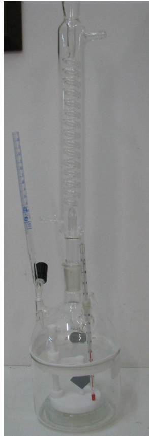
Figura 4: Fotografia do aparato montado com o termômetro o condensador a bureta e o porta amostras em seu interior (sem o phmetro por questões de fragilidade e manutenção).
