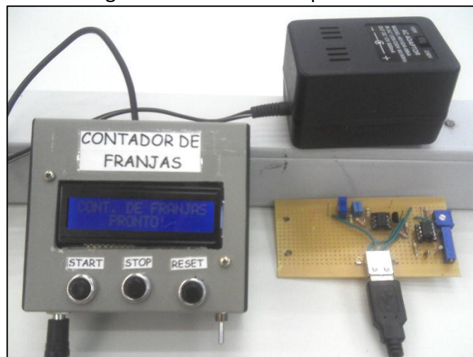
Figura 4.9: Montagem física do contador.
