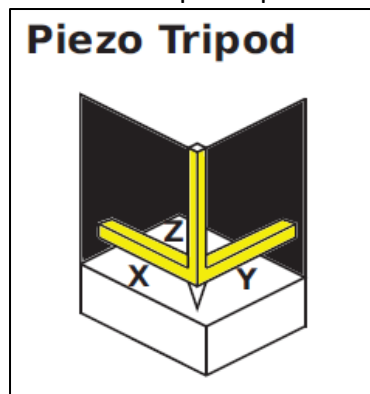
Figura 3.3: Esquema de funcionamento do atuador tipo Tripod (combinação ortogonal de três bastões) [8]
