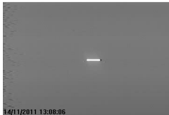
Figura 21- imagem obtida pela câmera com o laser incidindo diretamente em sua CCD de acordo com as montagens anteriormente descritas.
