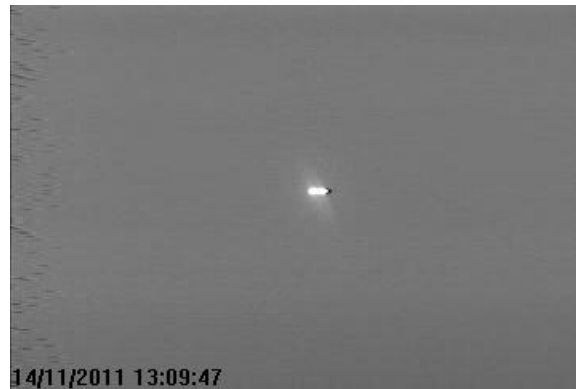
Figura 23- imagem obtida pela câmera com o laser incidindo diretamente em sua CCD de acordo com as montagens anteriormente descritas.
