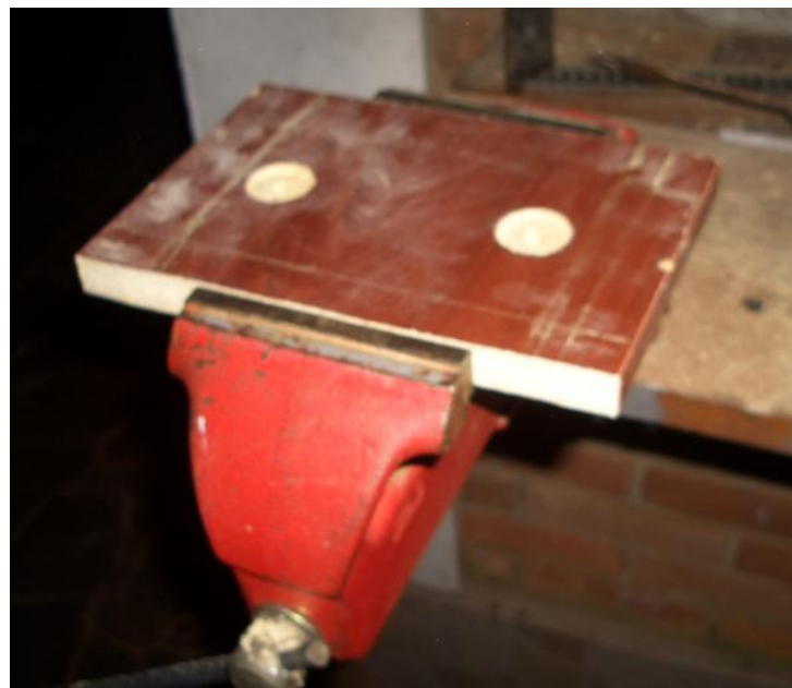
Figura 12 – Construindo a parte de cima da caixa onde ficam os jacks para conexão.
