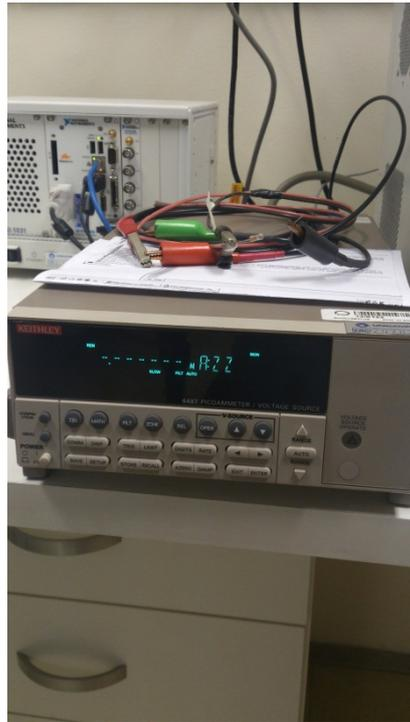
**Figura 21:** Foto do *picoamperímetro Keithley 6487* pronto para realizar medidas.
