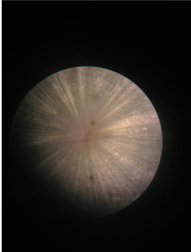
**Figura 10: Figura radial obtida após regularização da perpendicular do feixe com o DVD. Ela resulta da segunda ordem de difração, pois é gerada pela linha luminosa mais próxima do disco depois da primeira.**
