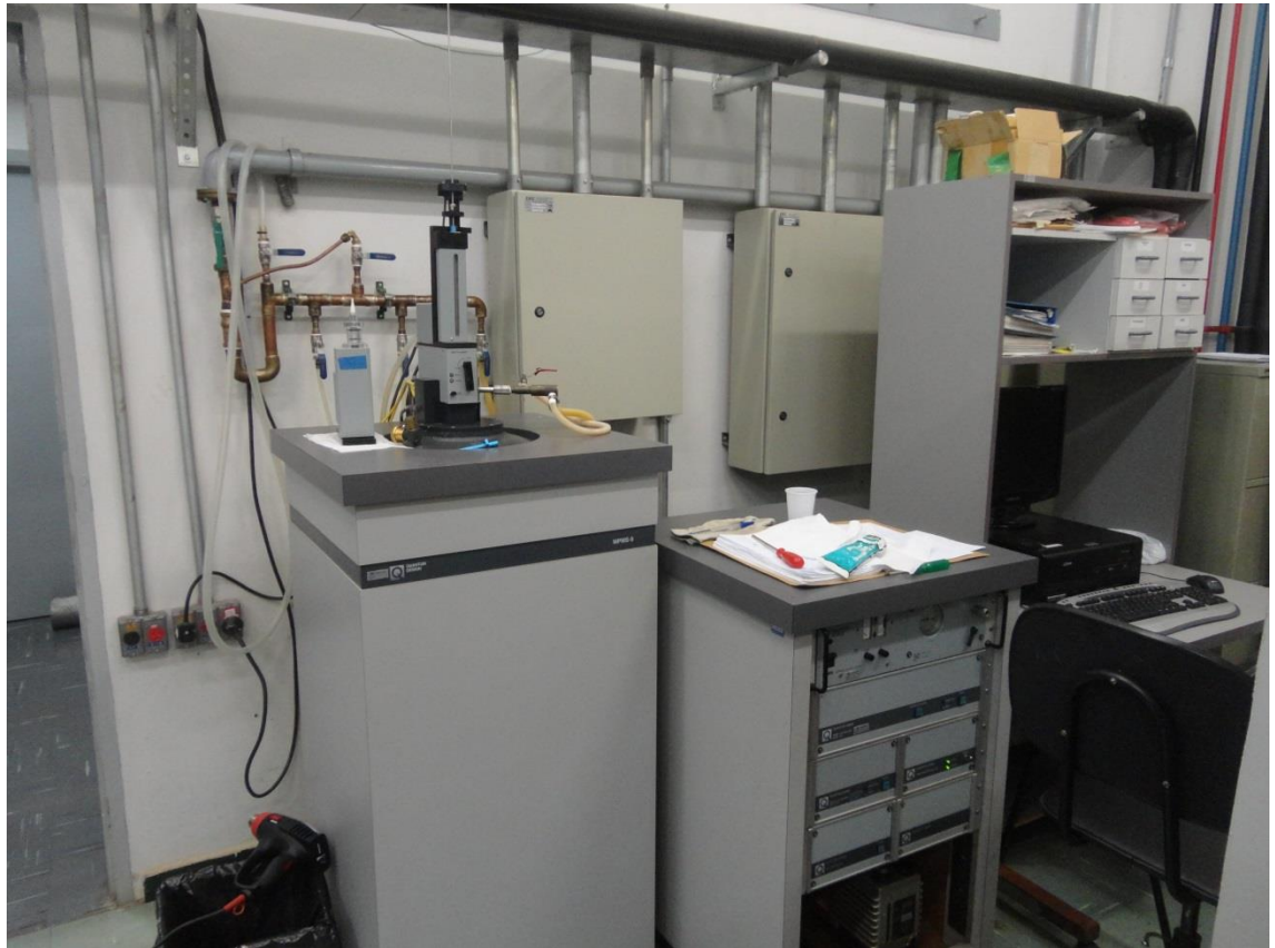
Figura 2.7: MPMS utilizado na medida de susceptibilidade magnética DC.
