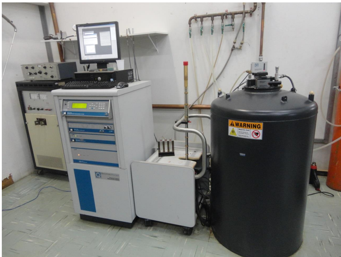
Figura 2.6: PPMS utilizado nas medidas de resistência e calor específico.
