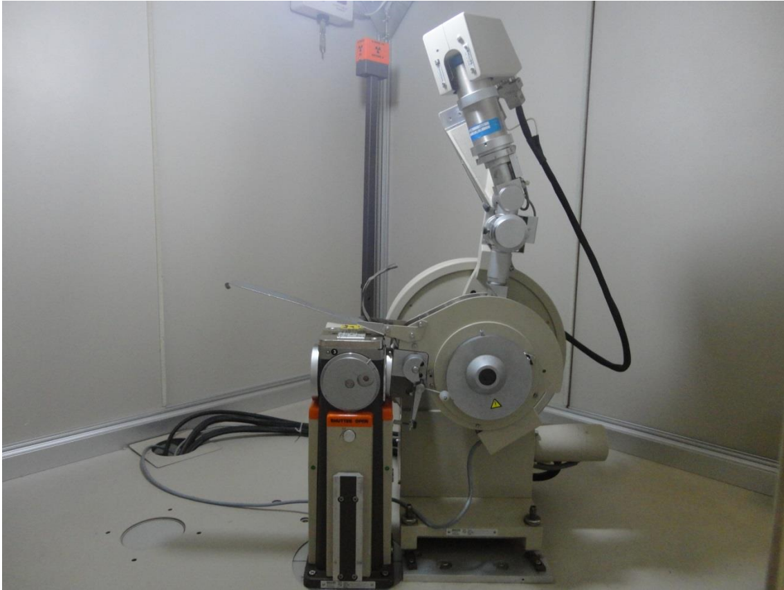
Figura 2.3: Equipamento utilizado nas medidas de difração de raios-X.
