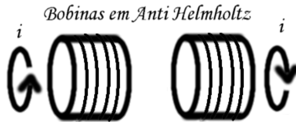
Figura 1: Dois solenóides em configuração de anti Helmholtz. A corrente da bobina direita circula no sentido horário e a da esquerda anti horário
