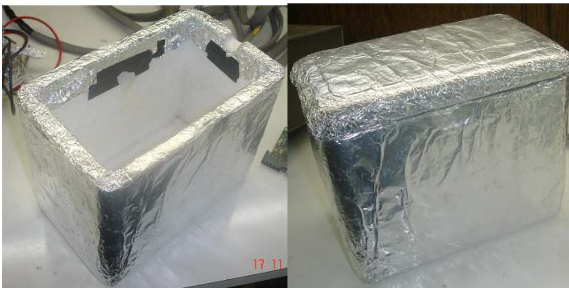
Figura 5 – Caixa para blindagem de ruídos elétricos, e medidas com amostra imersa em nitrogênio líquido.
