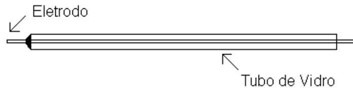
Figura 2 - Sonda de Langmuir
