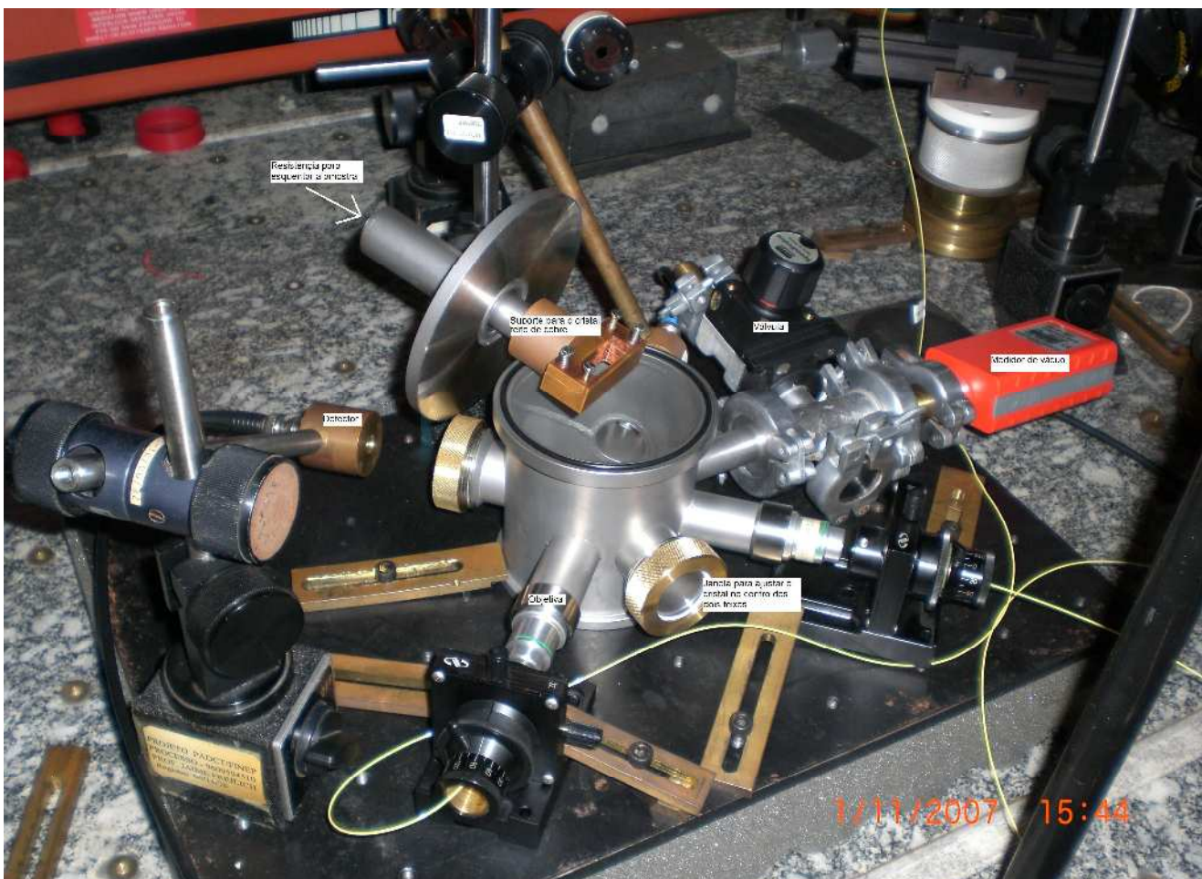
Figura 15: A montagem da câmara de vácuo
