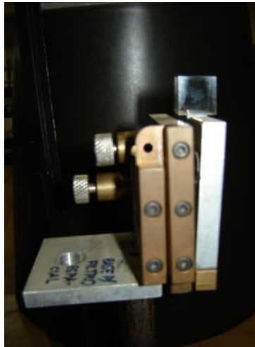
Figura 3: Cubo de vidro divisor de feixe (50/50%) fixo em um suporte com ajuste angular
