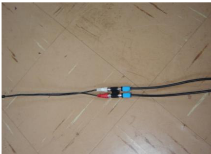
Figura 5: Conexão do cabo audio-vídeo (à esquerda) e duas saídas BNC
