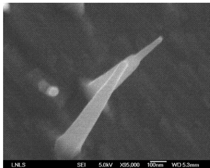
Figura 1 – Imagem por microscopia eletrônica de fios de GaAs. Em geral a orientação de crescimento dos não é paralela ao substrato.
