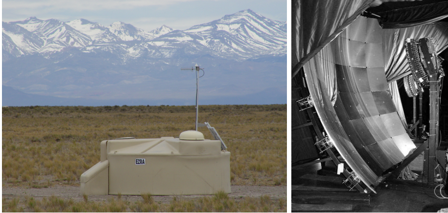
Figura 6: Um dos 1600 detectores de superfície (à esquerda) e um dos espelhos do detector de fluorescência (à direita).
