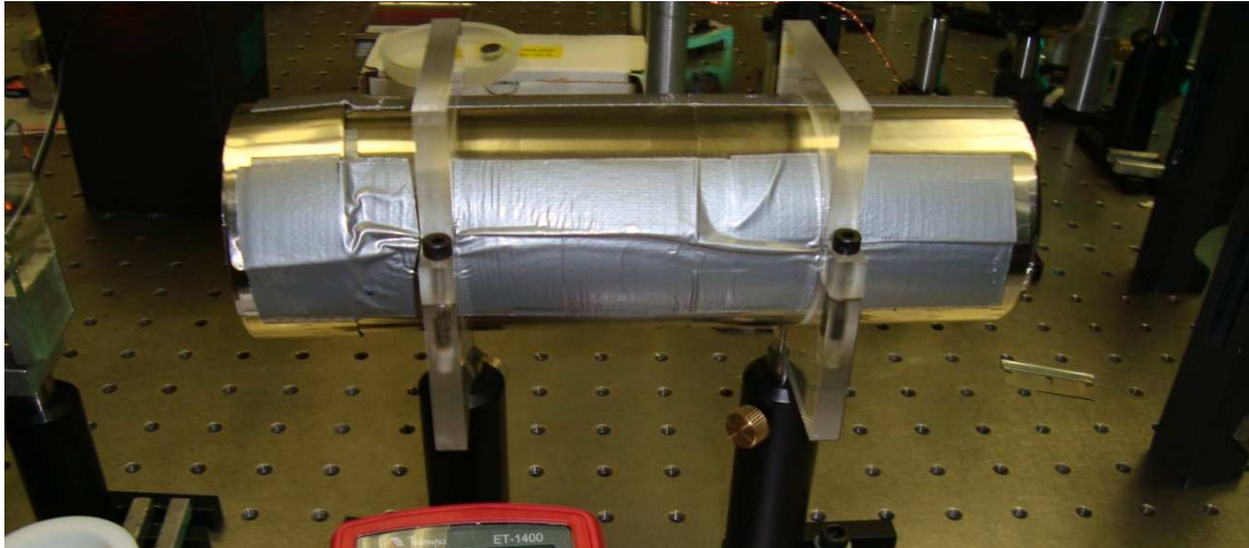
Figura 6: Foto do esquema final de aquecimento, já com o \mu -metal.
