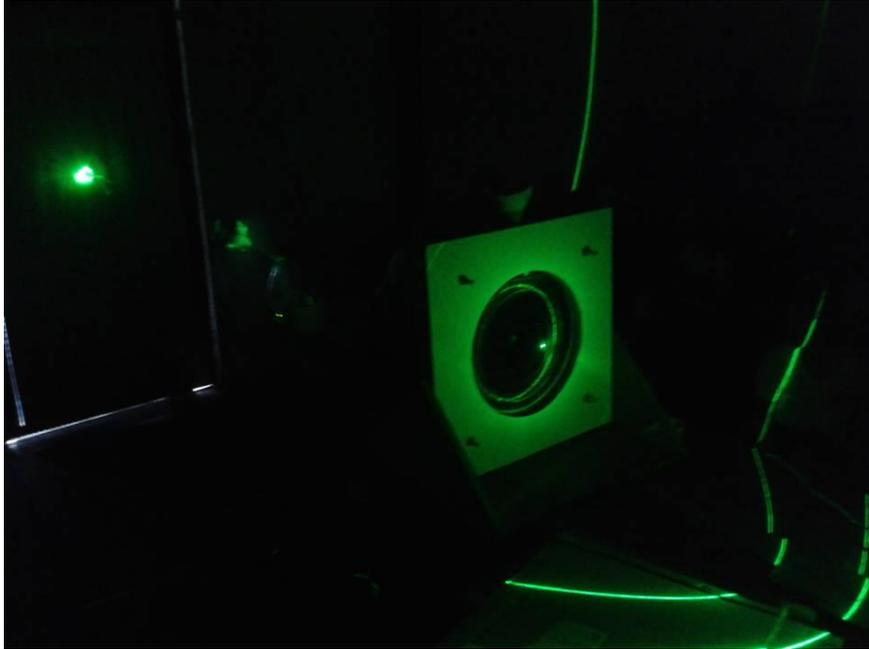
*Figura 2: Lente de água no centro e raios circulares de luz em volta. Detalhe para a focalização destes raios em um anteparo, à esquerda.*
