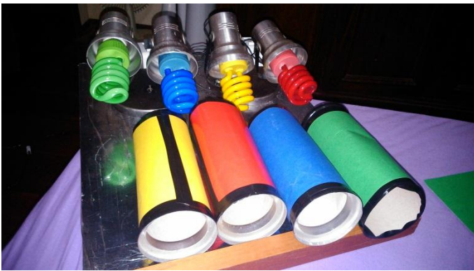
Figura 14: Montagem experimental evidenciando os direcionadores de luz, desencaixados das lâmpadas.
