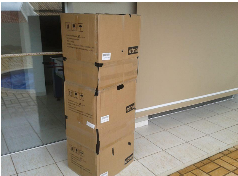
Figura 6: Câmara escura construída com caixas de papelão reaproveitadas.
