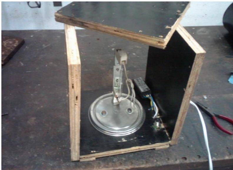
Figura 15: Proteção lateral da lâmpada de fendas.
