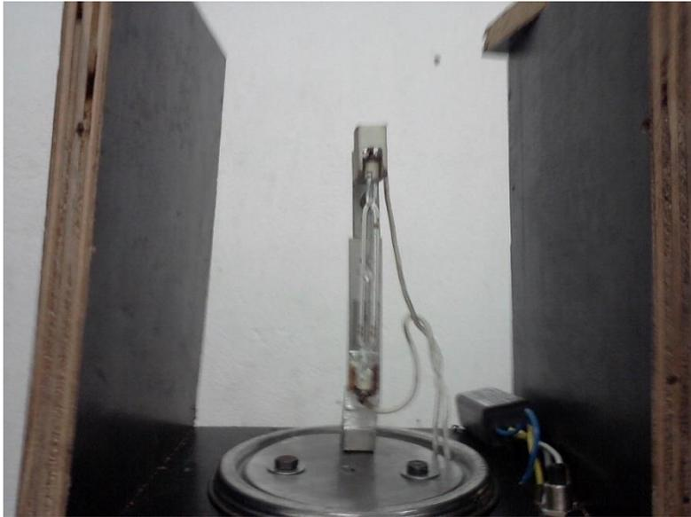
Figura 10: Suporte com calce utilizado para levantar a lâmpada.
