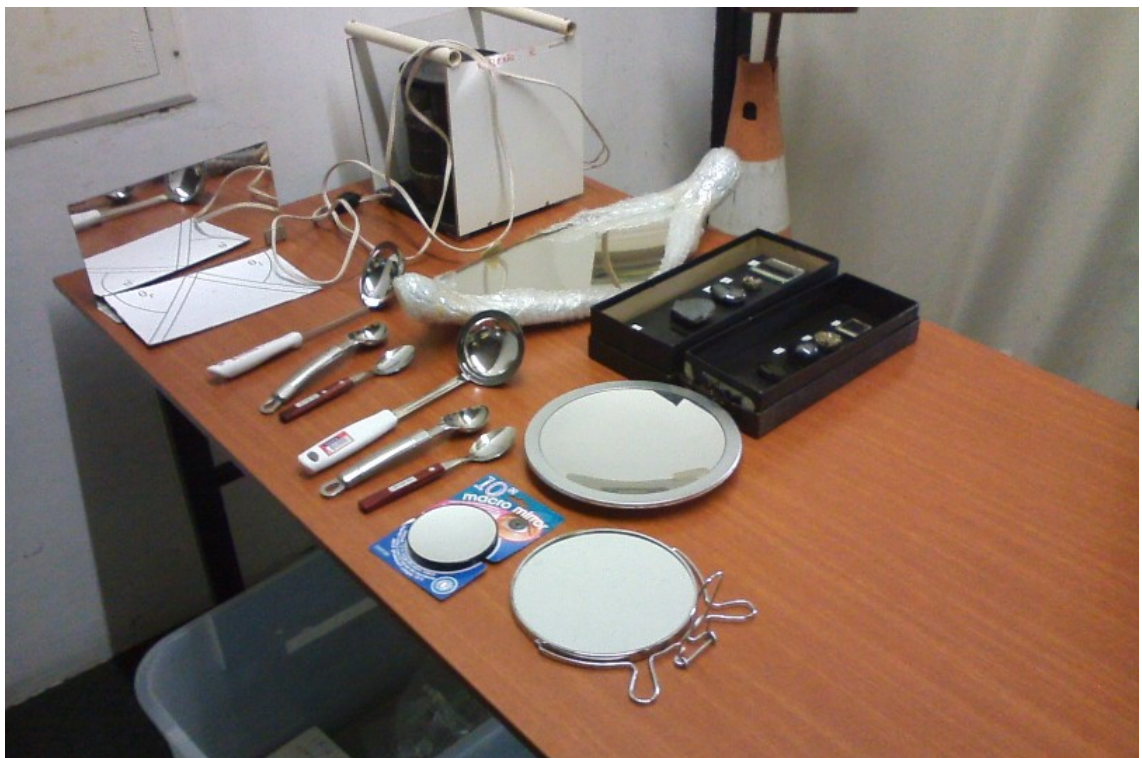
Figura 4 :Módulo duplo de reflexão com duas conchas de feijão, de sorvete, duas colheres, três espelhos côncavos em tamanhos diferentes, materiais com percentuais diferentes de reflexão, espelho côncavo grande, espelho plano, luz com temporizador em uma ou múltiplas fendas.
