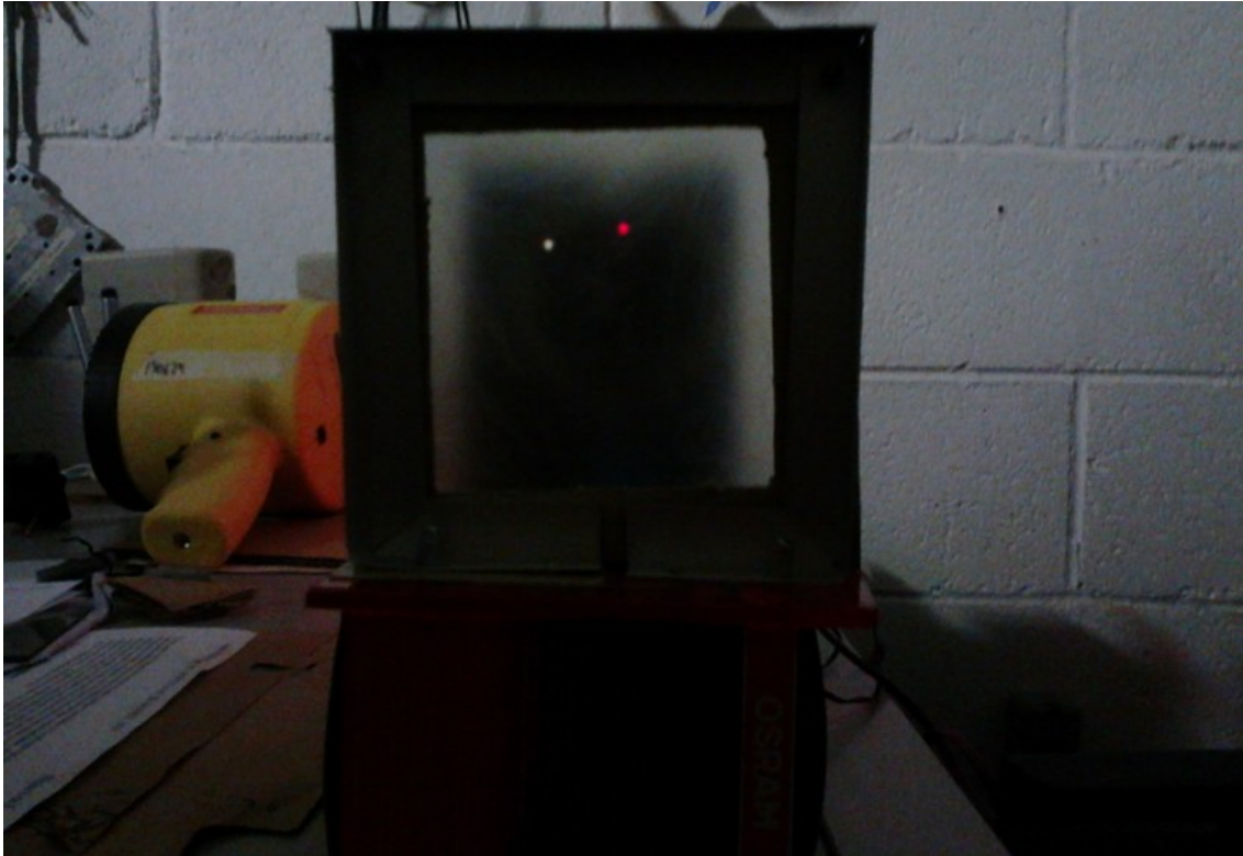
Figura 3: Tela posta na lente mostrando os dois pontos com a mesma nitidez.
