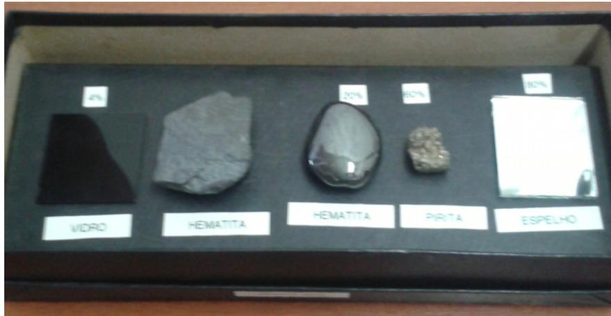
Figura 15 – Caixa com vários objetos diferentes com reflexão.
