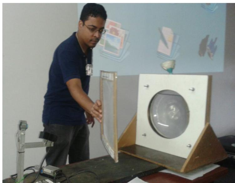
Figura 31 – Aluno Cassemiro utilizando a lente de glicerina com água para demonstração do ponto focal de convergência da luz.
