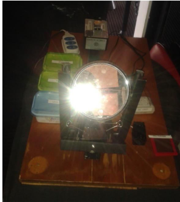
Figura 34 – Dispositivo para realização do experimento de formação de imagens 3D.
