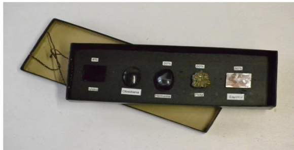
Figura 3:Experimento mostrando a reflexão de alguns materiais
