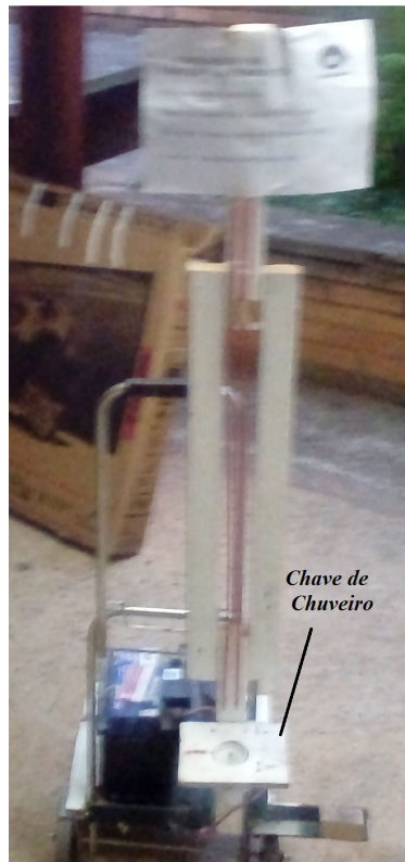
Fig.2 – Experimento utilizando a chave interna retirada de um chuveiro elétrico
