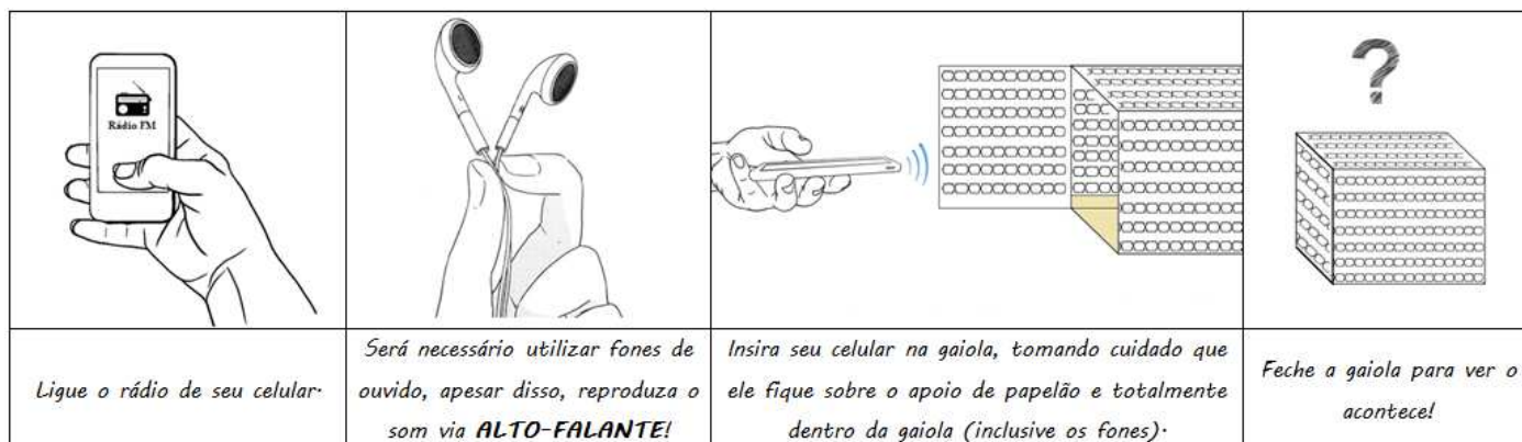
Figura 13 – Procedimentos que devem ser seguidos pelo usuário para realizar o experimento da gaiola de Faraday. Esta imagem também foi fixada no painel para ilustrar os passos necessários para a realização do experimento.
