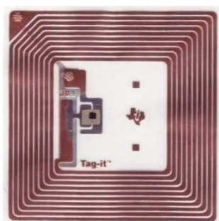
Figura 2 – Etiqueta de RFID. O sistema indutivo utilizado é baseado em um transformador do tipo acoplamento entre a bobina preliminar no leitor e a bobina secundária na etiqueta.
