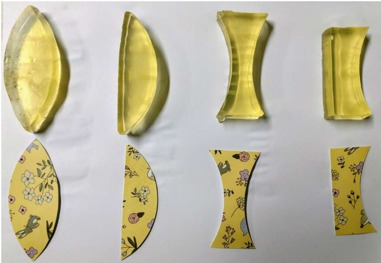
Figura 10: Algumas lentes cortadas seguindo os moldes feitos em cartolina.
