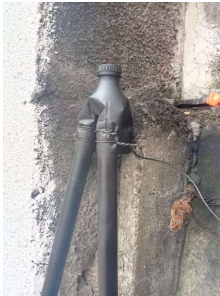
Figura 13: Fixação da garrafa PET na parte superior do tripé
