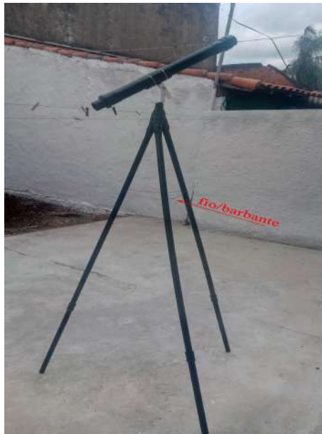
Figura 16: Montagem da luneta com tripé.
