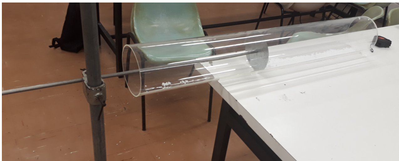
Figura 6: Montagem do Tubo de Kundt realizada na sala LF 10 no IFGW.
