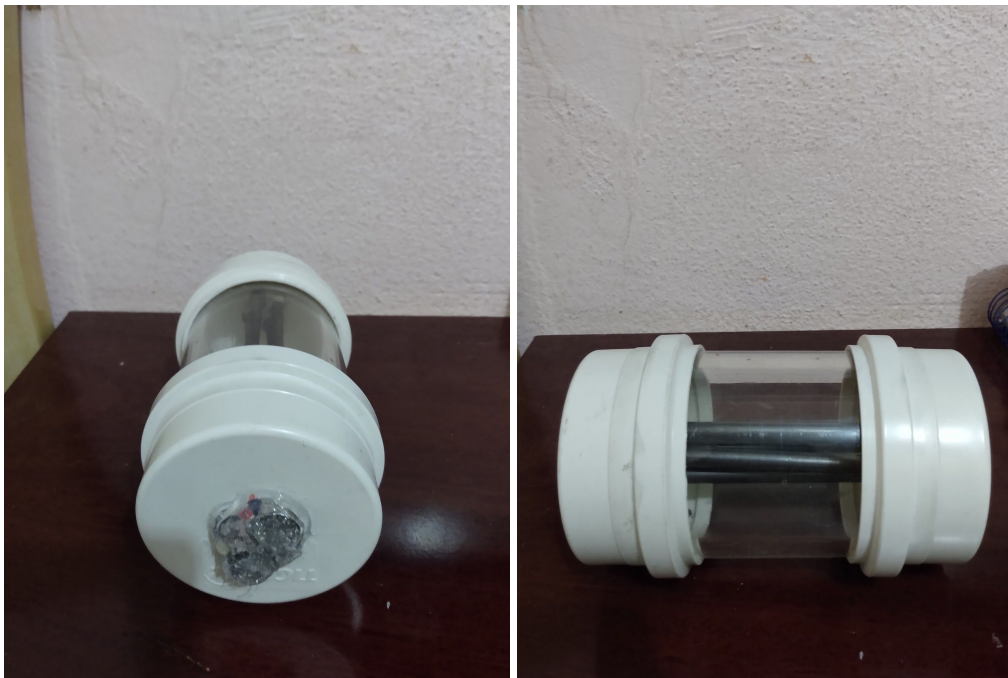
Figura 3 - Cilindro com distribuição de massa a 1 cm do centro.
