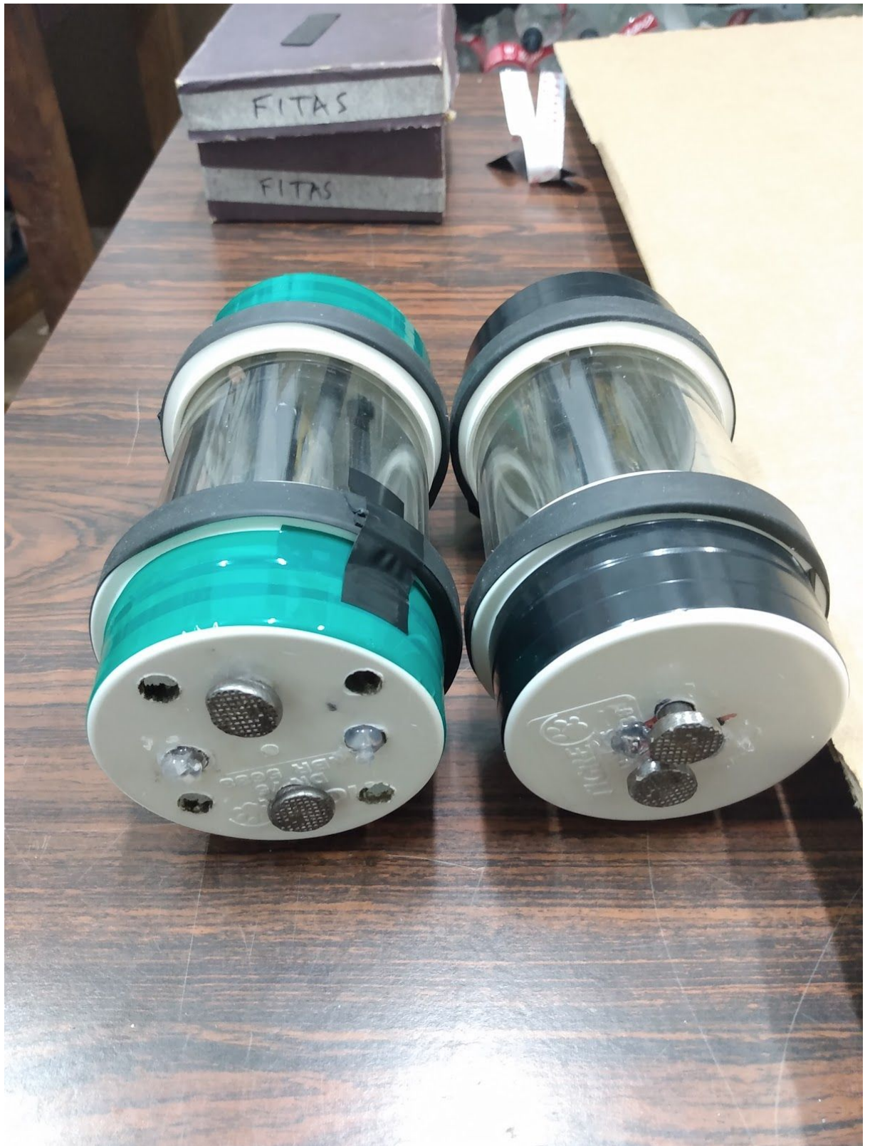
Figura 5 - Cilindros adicionado borracha para aumentar o atrito.
