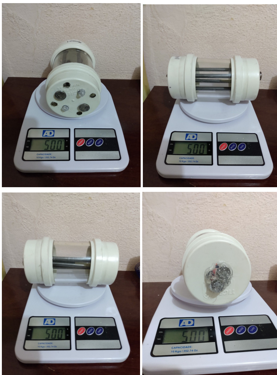
Figura 4 - Medição na balança de ambos os cilindros.
