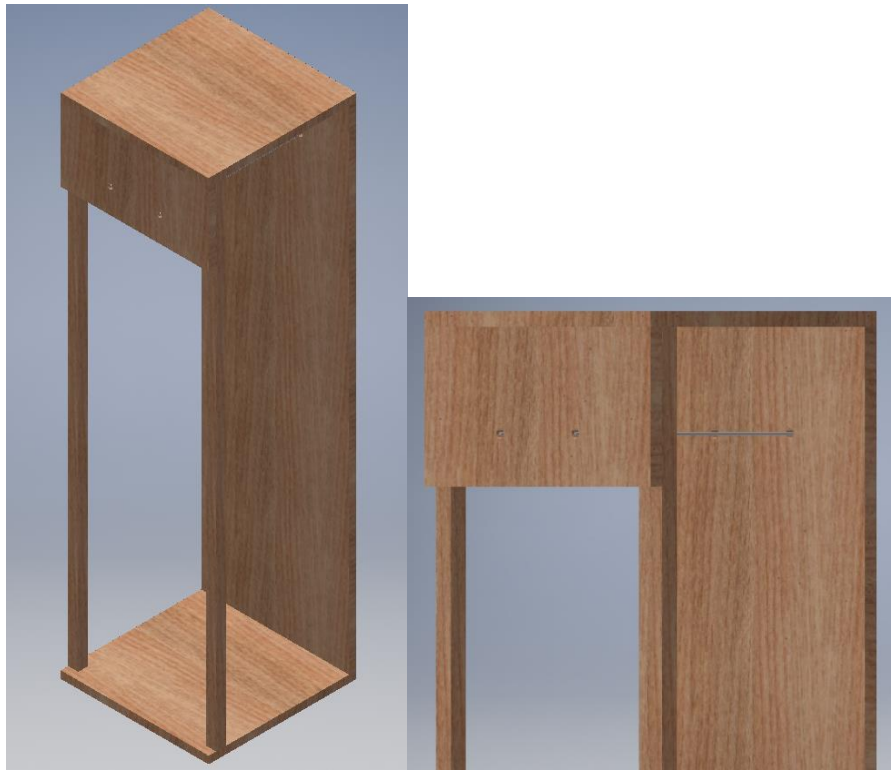
Figura 2 - Vista geral do desenho 3D da montagem feita no Inventor®(esquerda). Zoom para melhor visualização do Eixo que sustentará o fio tracionados(direita).
