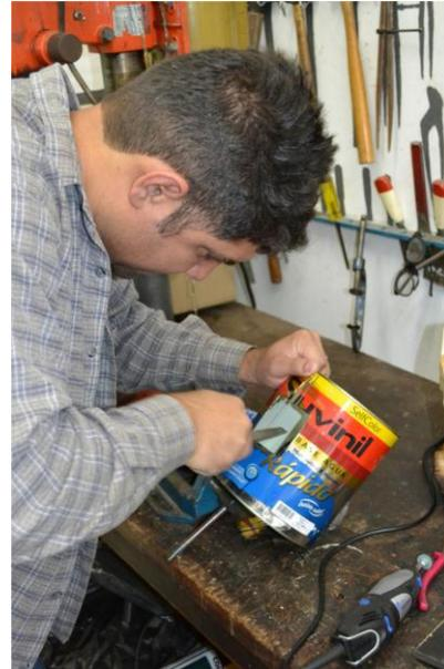
Figura 2: Retirando rebarbas com a lima
