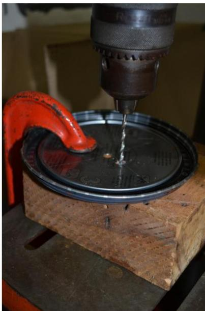
Figura 3: Fixação da tampa da lata para montagem da lâmpada
