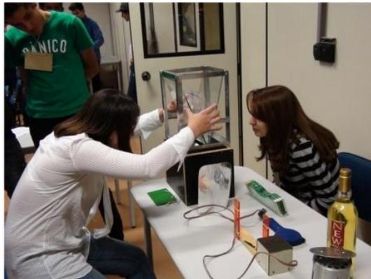
Prisma construído com duas faces de vidro com ângulo variável e um saco contendo água entre as lâminas, o fenômeno é visto quando se aperta as faces do prisma enquanto a luz o atravessa.
