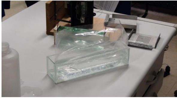
Cuba vidro que é preenchida com um saco contendo água, o fenômeno é visto quando é modificado seu ângulo no plano horizontal quando um feixe de luz o atravessa, utilizado tanto frente ao rosto, como com uma lâmpada de fenda.
