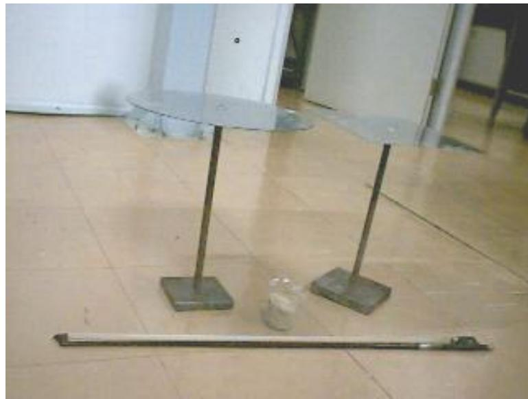
*Figura 4 – montagem experimental para a realização do experimento. A placa é presa a haste utilizando-se um parafuso.*
