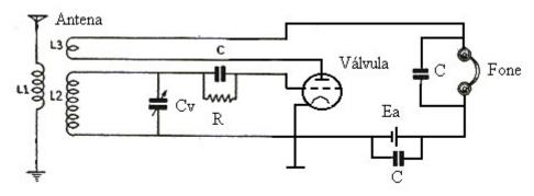
Fig.1 – esquema do circuito do rádio regenerativo com válvula.
