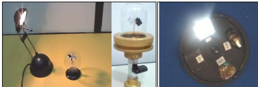
Figura 19 - a) Radiômetro; b) Demonstração utilizando vidro simples, hematita e pirita.
