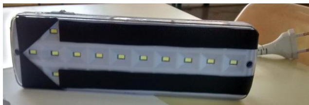
Figura 30- lâmpada de emergência adaptada como fonte de luz
