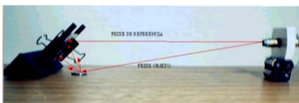
Figura 22 - Sistema caseiro para gravação de hologramas
