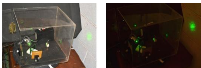
Figura 20 - Interferômetro de Michelson caseiro em funcionamento
