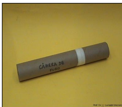
Figura 4 - Modelo da Câmara Escura de Orifício proposta por Lunazzi
