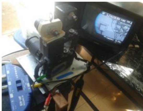
Figura 1: Processo de ajuste do ângulo vertical da câmera utilizando uma televisão.
