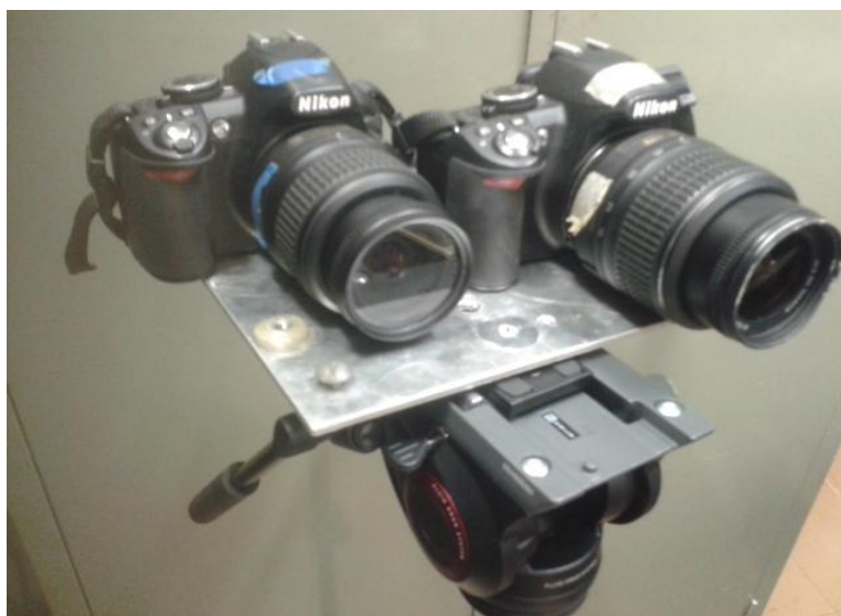
Fig. 6: Câmera 3D composta de duas Nikon profissionais.
