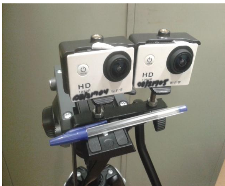
Fig. 8: Câmera 3D composta de duas câmeras de tipo esportivo.
