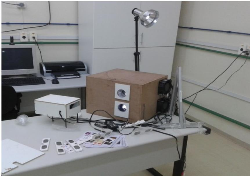
**Figura 1:** A câmera (á esquerda, na mesa) na direção de captação de imagem, e o projetor duplo (centro) com a lâmpada iluminadora acima e óculos polarizados na mesa.
