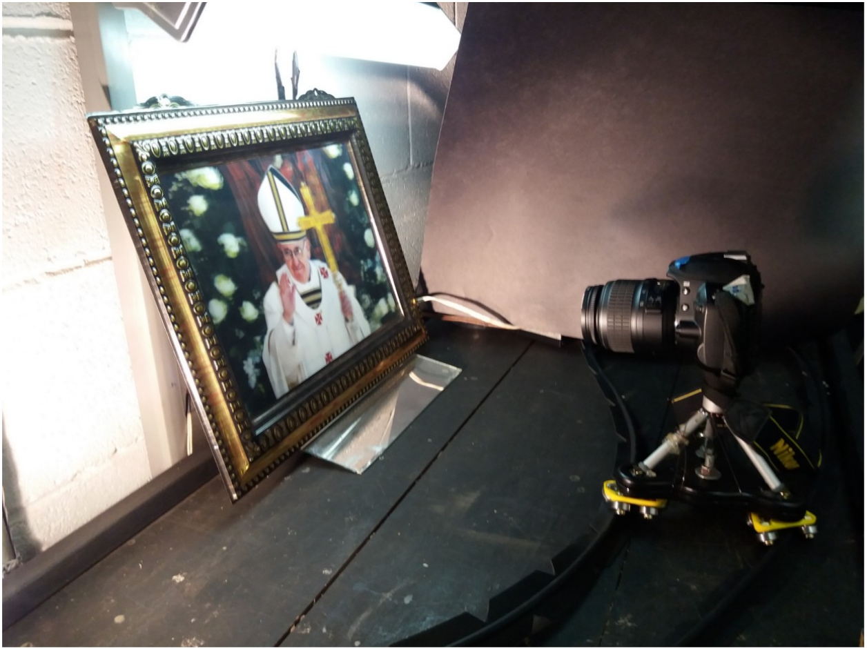
Figura 4: Sistema montado para obter um par estéreo a partir de fotografia lenticular
