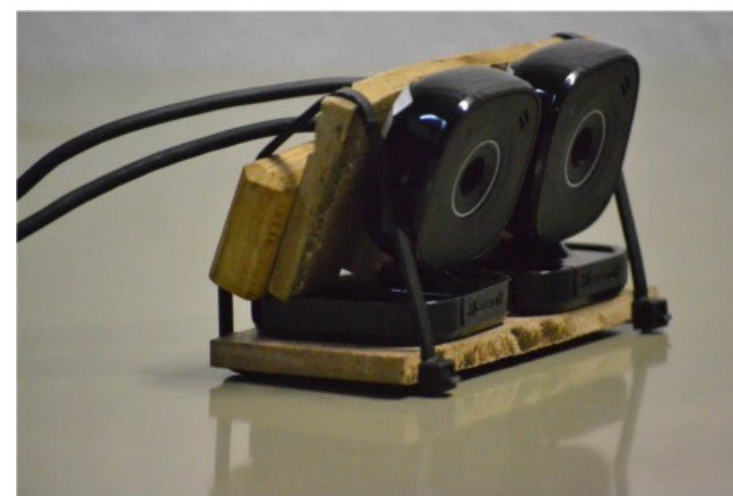
Figura 1: Montagem de duas câmeras web para transmissão pela internet, como na foto da Fig.2.
