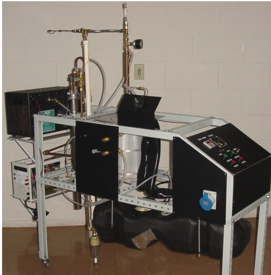
Protótipo Semi-Industrial desenvolvido no Laboratório de Hidrogênio para reforma-vapor do etanol.
