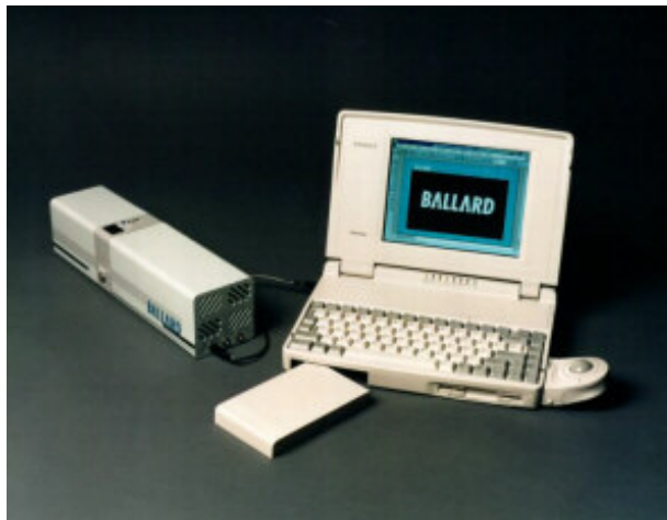
Foto de Laptop alimentado por uma célula a combustível tipo PEMFC.
